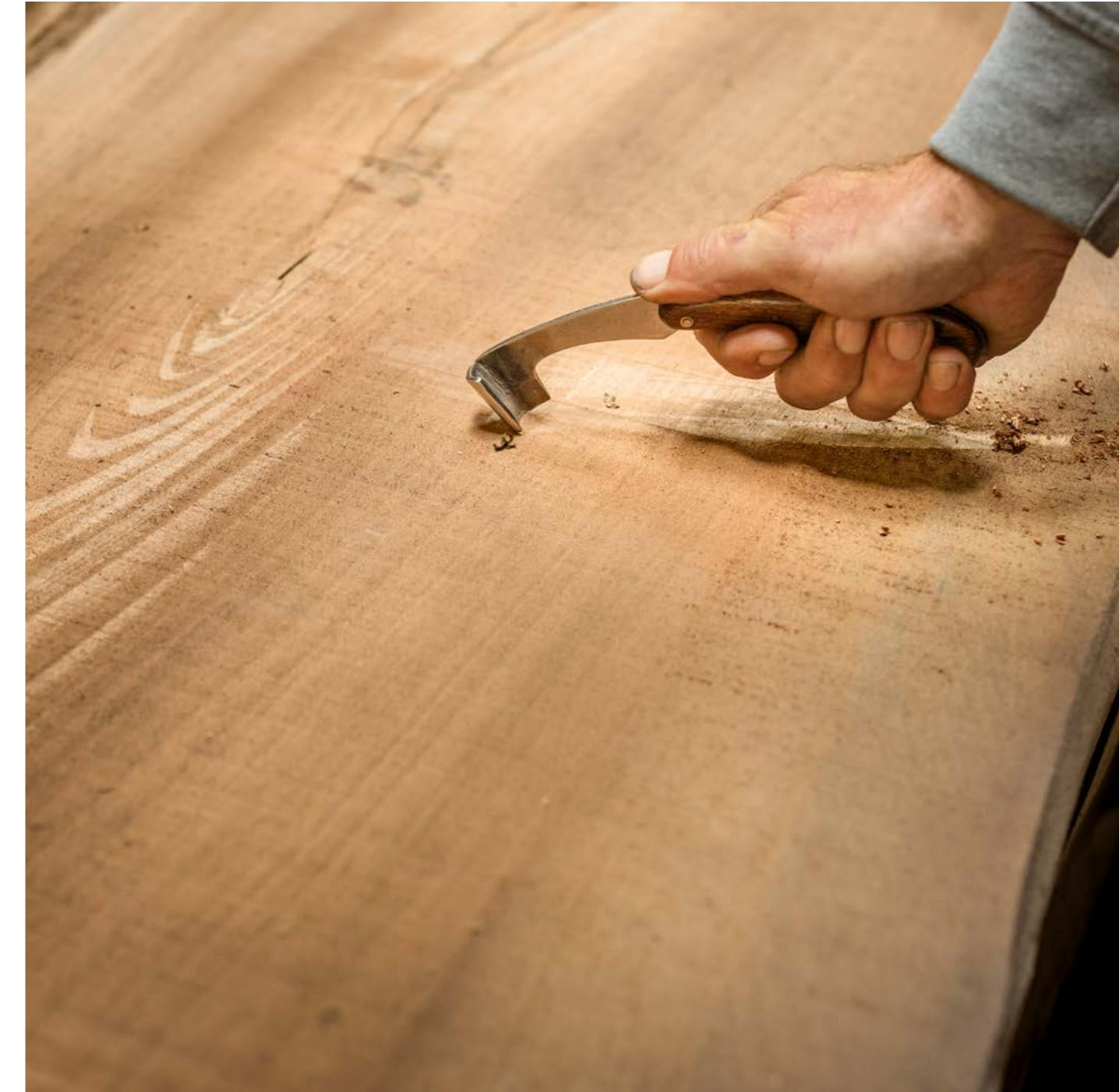
Während des Trocknungsprozesses im Außenlager verwittert das Holz, Sonne und Regen verändern die Farbe des Holzes. Zudem setzt sich in den Holzlagern mit der Zeit viel Staub ab. Durch ein Aufschaben der Brettoberfläche mit einem kleinen Ziehmesser lässt sich erahnen, wie die Holzfarbe später nach der Verarbeitung aussehen wird.
