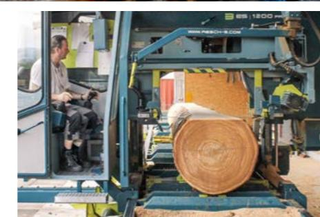
Mitte unten: Eine besondere Kenntnis der Sägewerke und vorhandener Maschinen ist erforderlich: Nicht jeder Stammdurchmesser kann überall gesägt werden.
