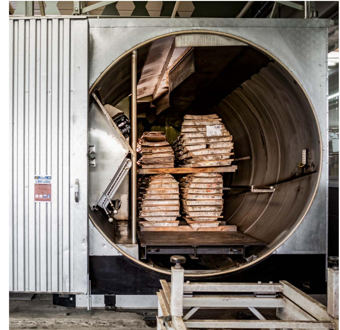
Nach dem Prozess der Luftplocknung im Freien oder in einem Innenlager stehen zusätzlich als technische Verfahren mehrere Umluft- und Vakuumkammern zur Verfügung. Damit wird das luftplockene Holz auf die branchenübliche Anwendungsfeuchte von 8–10% gebracht.
